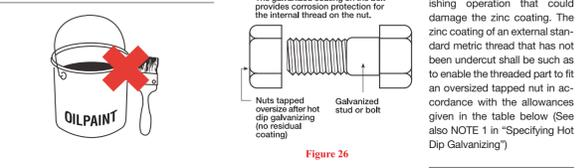
**OVERSIZE TAPPING ALLOWANCE FOR HOT DIP GALVANIZED NUTS**
